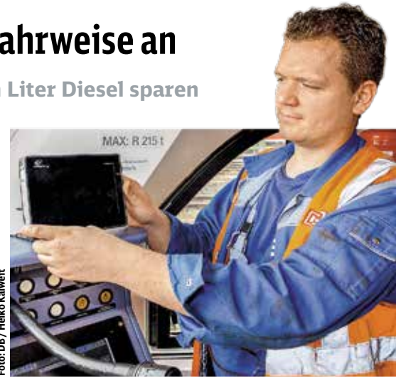
Einbau eines RESY-Geräts in einen Dieseltriebwagen
