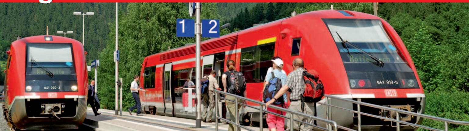
Niederflurtriebwagen VT 641: Maximal zwölf Jahre alt sind die Züge, die künftig auch in Bayern unterwegs sind. Bis zu drei Einheiten können in Mehrfachsteuerung fahren.
