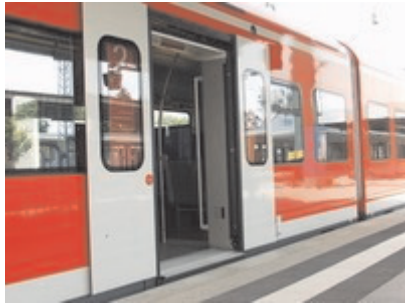
ET 425.2 mit ausgefahrenem Klapptritt und Blindenleitsystem am Bahnsteig
