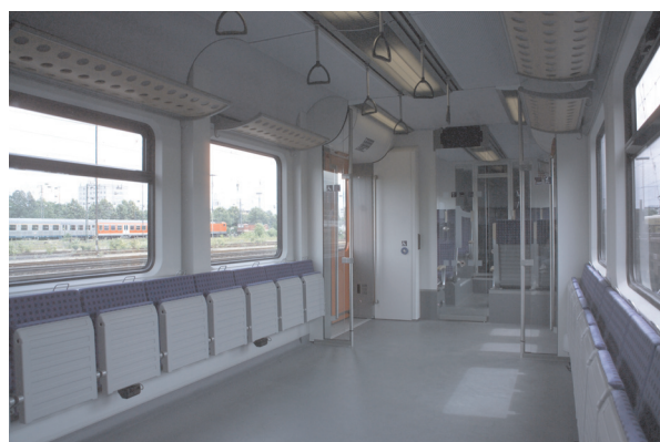
Mehrzweckraum mit Rollstuhlstellfläche
